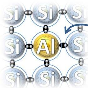
Es kann aber auch ein **Aluminiumatom (Al)** eingebunden werden. Al-Atome haben nur **drei Außenelektronen**. Es ist also ein Elektron zu wenig, es entsteht ein „Loch“ im Verbund. Man bezeichnet das Material als „**p-dotiert**“ (p → positiv-dotiert).
